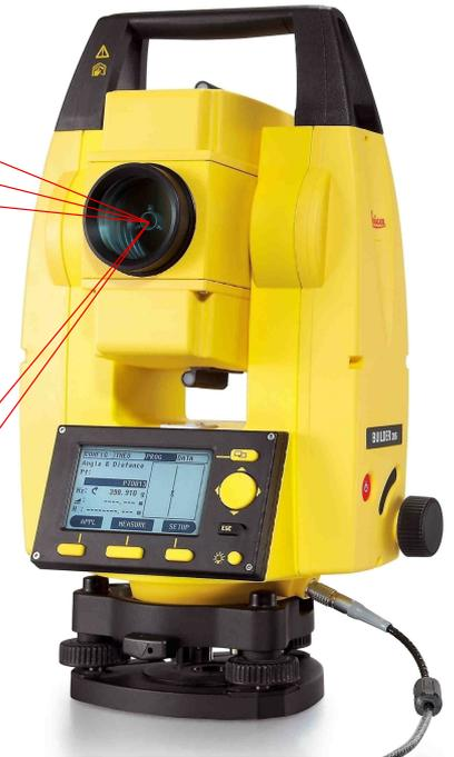
Datenübertragung über Bluetooth oder Kabel direkt ins cadwork 3d und direkt aus dem cadwork 3d zur Absteckung.
